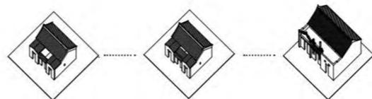
天井空間的逐漸縮小到消失的過程，是以谷埔為代表的沙頭角客家民居建築，在演變過程中一個顯著的共同點。儘管在廣東嶺南的傳統民居合院中，院落或是天井是最突出的空間特徵，在當代遺留並可識別的新界客家民居中卻幾乎已經找不到存在的痕跡。例如谷埔老圍第二排的李屋遺址，可以從殘存的牆基和凹斗式入口的簷口明確推斷出原本天井的位置和作為公共空間的關鍵地位，不過也同時可以看出原本方形的天井空間，由於入口屋簷的延長已經變成了一條細長夾縫。在其他例子中，屋簷甚至直接延伸至正廳外牆，天井從而完全消失。這是傳統漢民居的三開間合院原型在近代發展過程中關鍵性的變革，也宣告了傳統合院作為民居原型的結束<sup>24</sup>。
