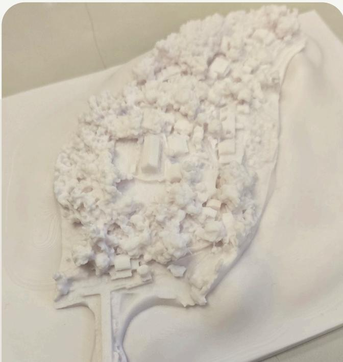
首次 3D 打印測試，打印了村莊局部區域的精細模型
