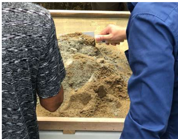
3. 在木盤放進黑英泥、沙，比例為 1:3（黑英泥：沙），用灰匙攪拌均勻。
