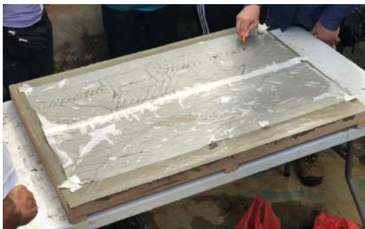
13. 將畫好稿的牛油紙鋪在木盤上，用剝刀在砂漿上刻出線條、線稿。
